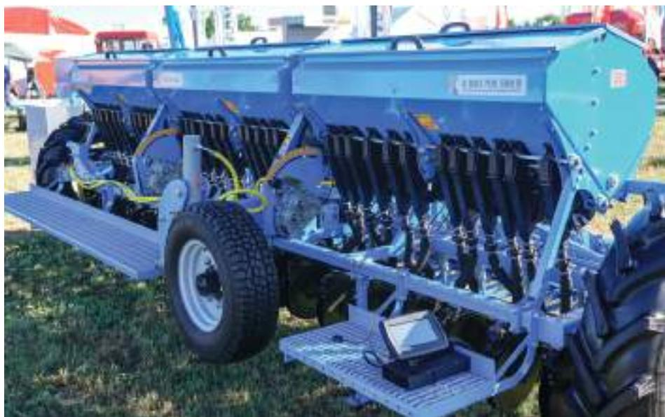
**СЕЯЛКА ВИТА СЗ-5,4 С СИСТЕМОЙ КОНТРОЛЯ ВЫСЕВА**
